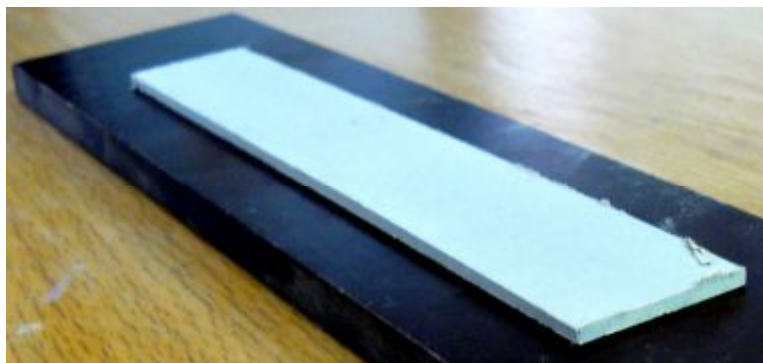
Рис. 2. Отпрессованная деталь волновода из сегнетокерамического материала на основе барийстронцийциркониевого титаната
