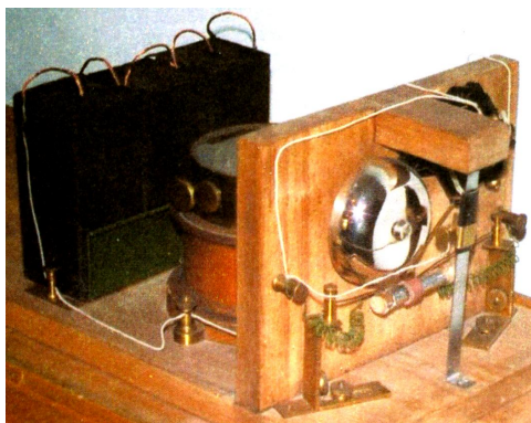
Рис. 24. Радиоприемник Попова конца 19-го века [13]
