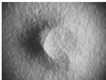
Рис. 2. Образец сегнетокерамического покрытия, нанесенного на медную подложку методом вакуумного аэрозольного напыления при комнатной температуре
