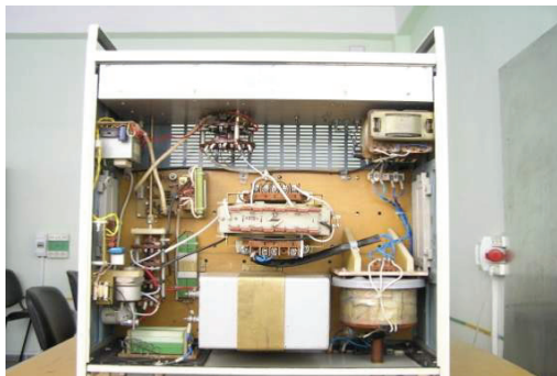
Рисунок 5 – Расположение элементов внутри корпуса генератора ИГЛА-МКУ-4
