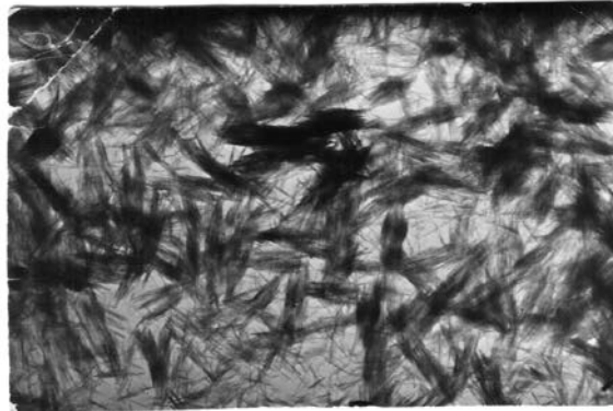
Рисунок 1 – Волокнистый продукт со структурой \left( \begin{array}{c} -\text{Al} \\ \diagdown \\ \text{O} \\ \diagup \\ -\text{Al} \end{array} \right) - \text{HO} - \text{Al} после выдержки при 800 °С. Увеличение в 20000 раз
