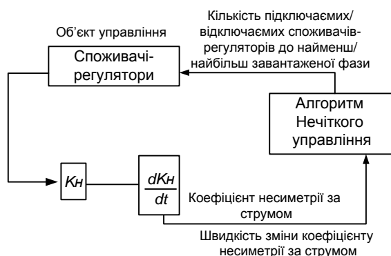
Рисунок 4 – Симетрування режимів роботи системи електропостачання побутового сектору
