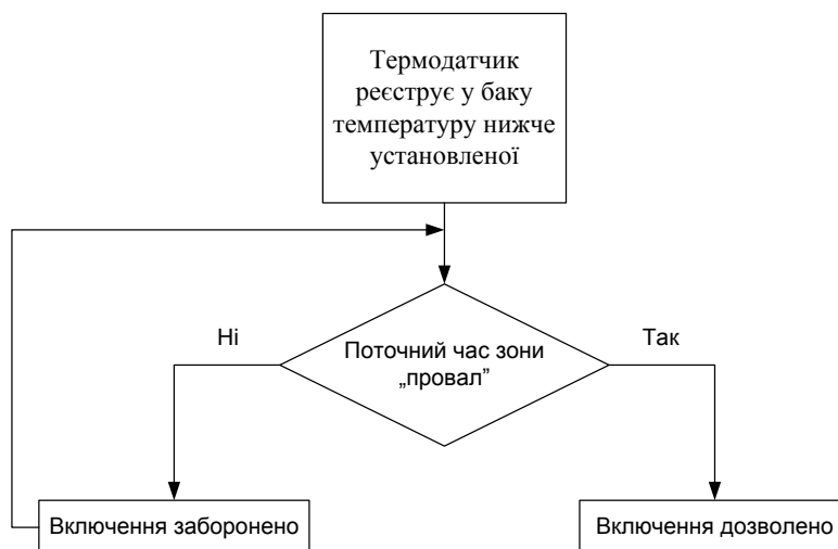
Рисунок 2.8 – Алгоритм управління побутовим ЕВН накопичувального типу
