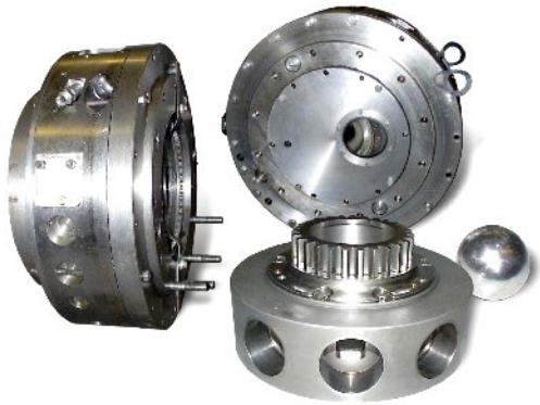
Рис. 1. Гидропередача ГОП-900 конструкции ВНИИГидропривод и ХКБМ им. А.А. Морозова с шариковыми поршнями [18]
