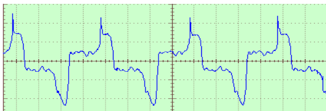
Рисунок 27 - Характерна осцилограма струму через ОПН 6 кВ отримана о 16 годині.
