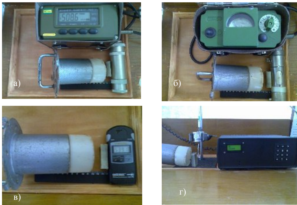
Рис. 3. Вимірювання потужності дози за допомогою приладів від джерела \text{Cs}^{137} (662 кеВ) з поглиначачем ( парафін товщиною 1 см): а) МКС-У; б) ДП-5В; в) МКС-05 «Терра»; г) Лабораторна установка
