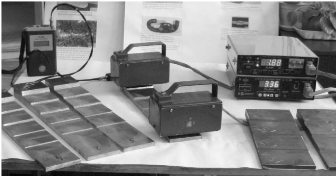
Фото 1 – Заміри коерцитивної сили H_c на зразках зі змінними перерізами різними структуроскопами типу КРМ-ЦК-2М
