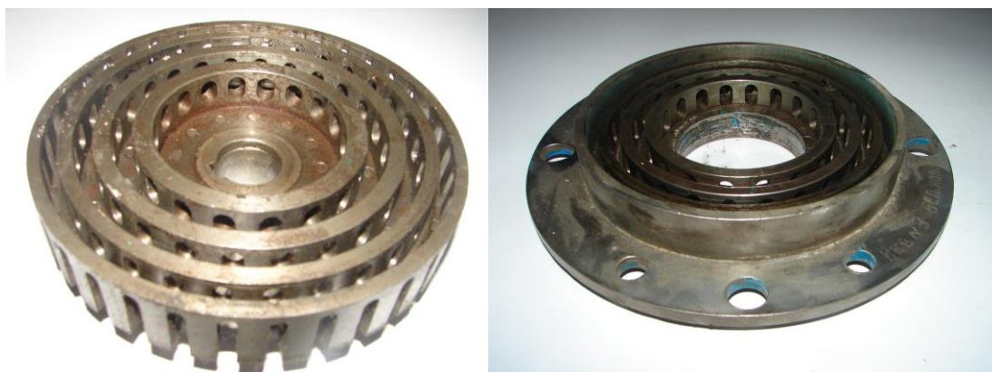
Рисунок 2 – Рабочие органы насоса
