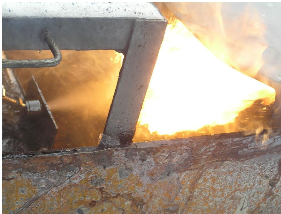
Рисунок 10 – Сжигание ИКЖТ с помощью смесителя-форсунки
