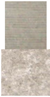
Рис. 9 – Циліндрична поверхня поршня з АЛ 25 до і після корундування
