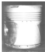
Рис. 12 – Поршень з корундовим шаром дизеля тепловоза ЧМЕ–3: а – до випробувань, б – після напрацювання 114676 мотогодин
