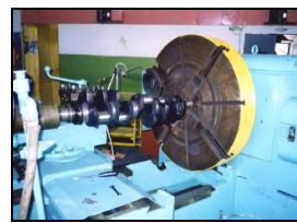
Рис. 5 – Дискретно зміцнений колінчастий вал двигуна КамАЗ для встановлення на шасі установки "Град"
