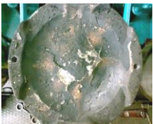
Рис. 11 – Серійний поршень дизеля K6S310DK відпрацював 46512 мотогодин
