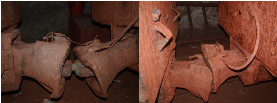
Рис. 5. Иллюстративное фото двух крайних положений сцепного устройства электровозосостава
