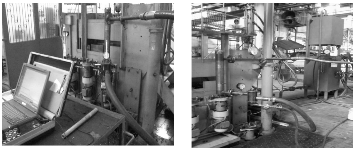
Рисунок 6 – Загальний вигляд експериментального стенда та багатоканального вимірювального комплексу для дослідження ЛГН
