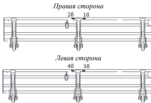
Рис. 3 – Схема расположения тензорезисторов на вагоне при испытании бокового борта
