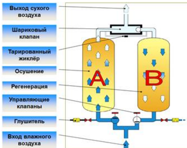
Рис. 2 – Схема работы фильтров-осушителей сжатого воздуха адсорбционного типа
