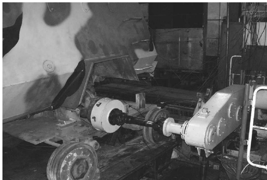
Рис.7. Подключение входного вала суммирующего редуктора к ступице заднего колеса бронеавтомобиля
