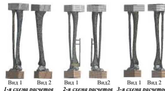
Рис. 7. Конечно-элементная модель с дополнительными элементами
