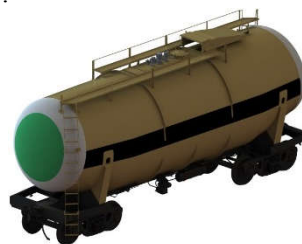
Рис. 1 – Вагон-цистерна для метанола
