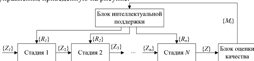
Рис. Схема многостадийного производства с комплексной системой интеллектуальной поддержки управления
