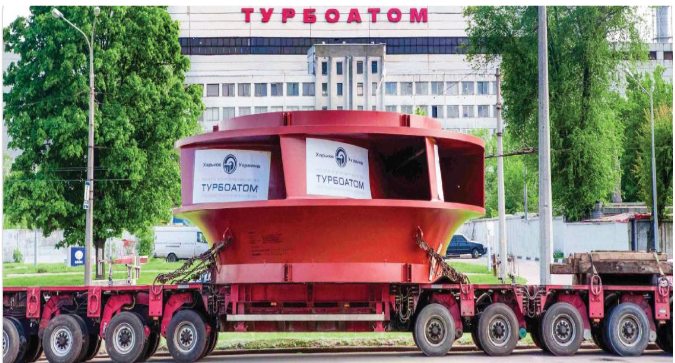
Рис.13 – Отгрузка рабочего колеса \varnothing = 7,3\text{м} , m=120\text{т} . спецтранспортом
