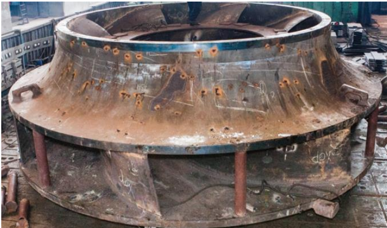
Рис. 6 – Рабочее колесо Днестровской ГАЭС после сварки
