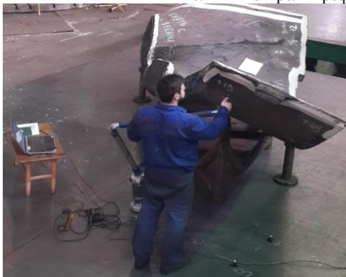
Рис.12 – Контрольная разметка лопасти под механическую обработку
