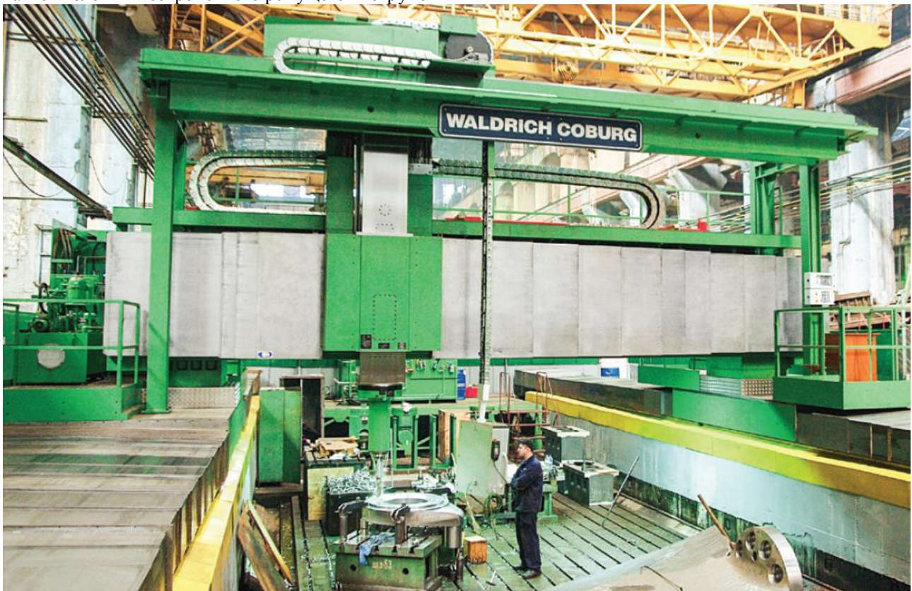
Рис.7 – Модернизированный портално-фрезерный станок мод. HC33-Waldrich Coburg (Германия)
