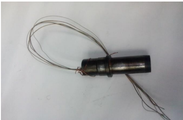
Рис. 1 – Препарована для термометрії серійна напрямна втулка
