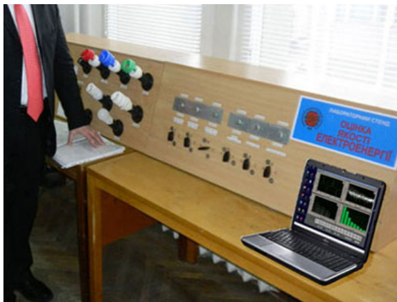
Рисунок 2 – Електронна лабораторія для вивчення дисципліни «Системи силової електроніки в електроенергетиці»
