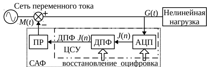
Рис. 10 Простейший параллельный активный силовой фильтр.
