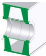
Рис.4. Грани деталей, относительно которых задается симметрия
