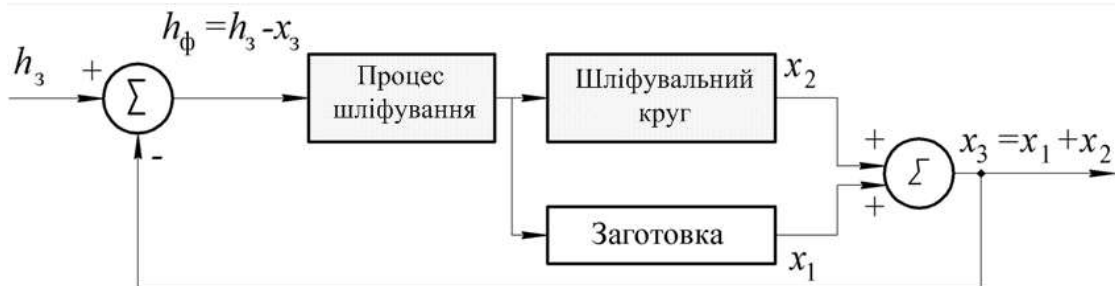
Рисунок 11 – Функціональна схема замкнутої динамічної системи переривчастого шліфування
