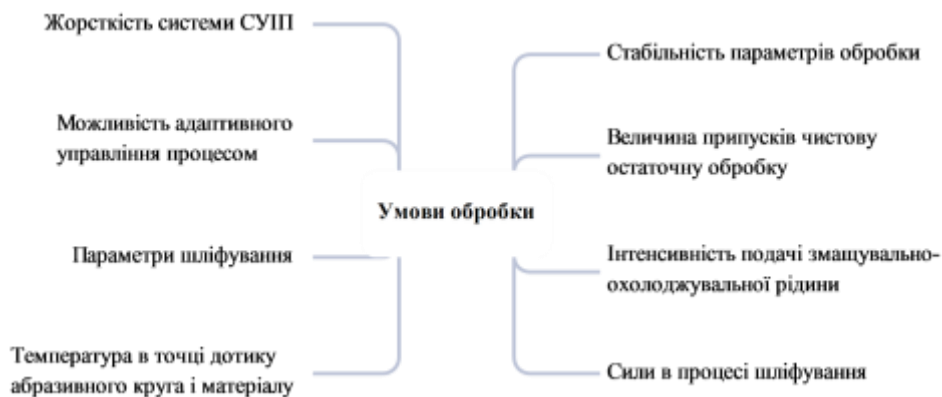
Рисунок 1 – Вплив умов обробки на формування поверхневого шару
