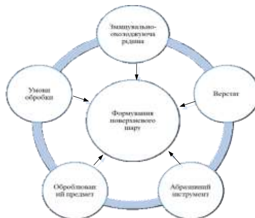
Рисунок 2 – Вплив факторів технологічного процесу на формування поверхневого шару
