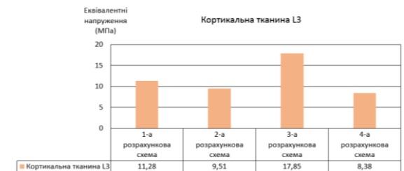
Рис. 13 – Максимальні еквівалентні напруження – кортикальна тканина L3
