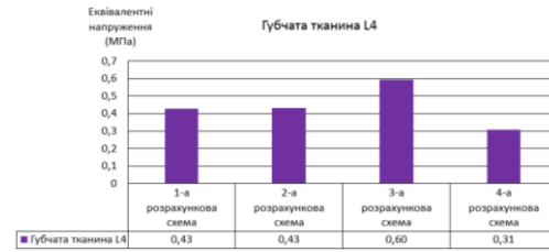
Рис. 20 – Максимальні еквівалентні напруження – губчата тканина L4
