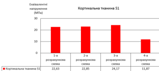
Рис. 16 – Максимальні еквівалентні напруження – кортикальна тканина S1
