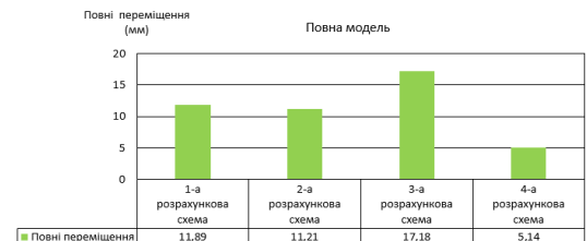
Рис. 34 – Повні переміщення – повна модель
