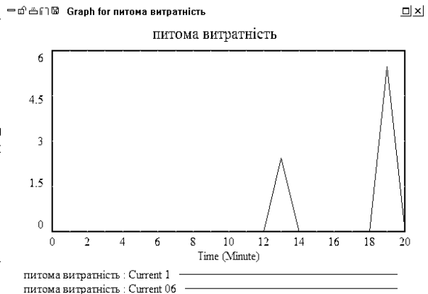
Рис. 15 – Характер питомої витратності (кВт кг год / кг): а – апарат без відбивача (Current 1), б – апарат з відбивачем (Current 06)
