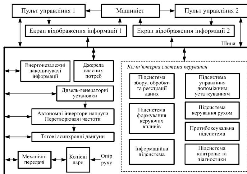
Рисунок 1 – Структурна схема дизель-поїзда ДЕЛ-02
