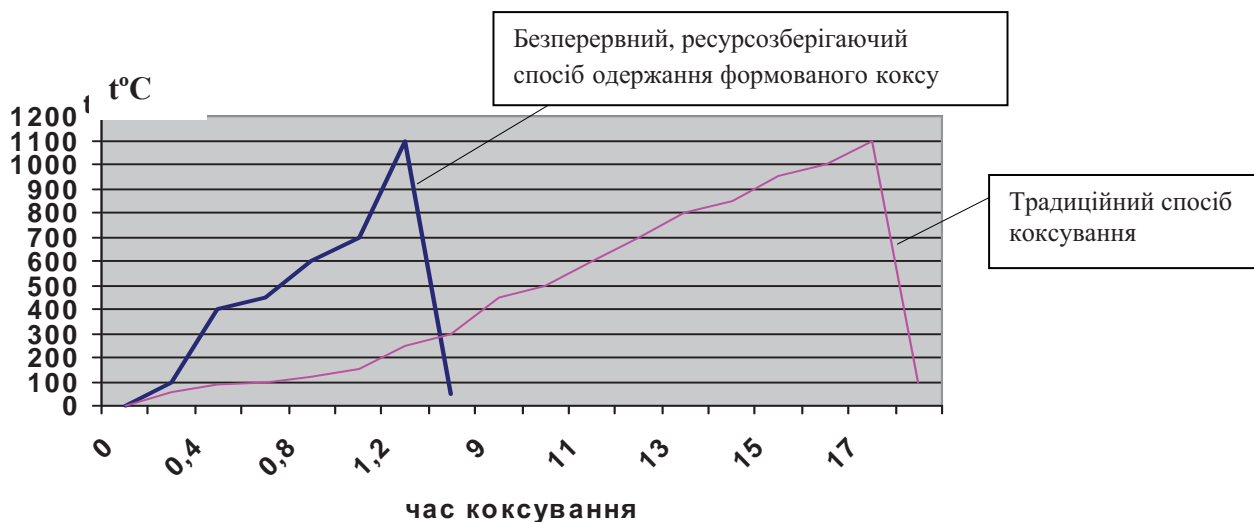
Рис. 1. Графік тривалості та режимів коксування
