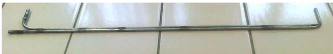
Рис. 2. Трубка Пито для определения скорости воздушного потока
