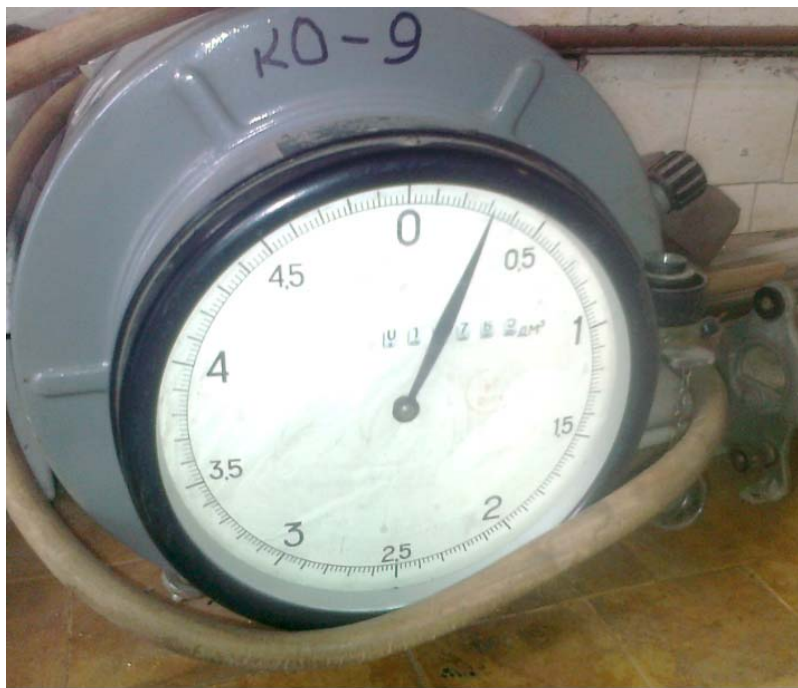
Рис. 3. Прибор для измерения расхода воздуха – газосчётчик барабанный ГСБ-400
