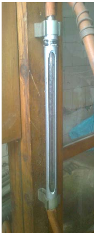
Рис. 7. Ротаметр для измерения расхода жидкости
