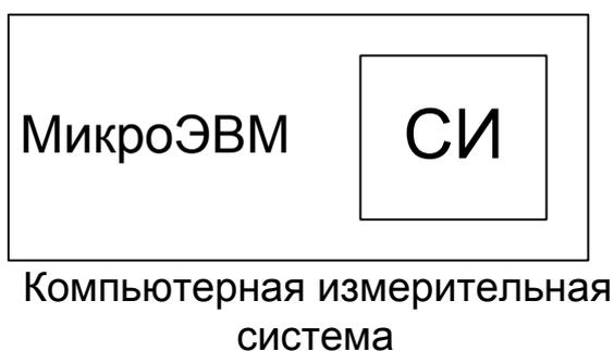
измерительные и управляющие устройства на одной или нескольких платах и конструктивно объединить с МикроЭВМ. Эта интеграция позволяет создать компьютерные измерительные системы (КИС), обладающие практически такими же возможностями, как и ИВК, но при значительно меньших затратах. Роль приборного интерфейса в КИС выполняет собственная общая шина МикроЭВМ.
