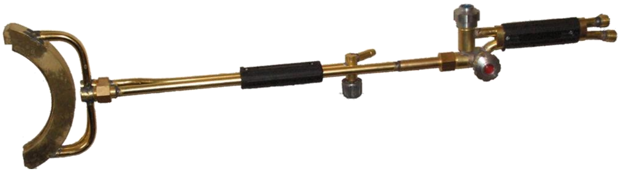
Рисунок 7 – Горелка для термообработки шеек крупногабаритных валшестерен
