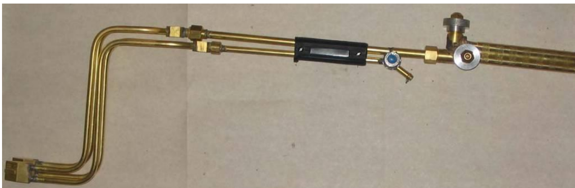
Рисунок 4 – Закалочная горелка ГЗУ6-КМ12 для зуба m=10 внутреннего зацепления
