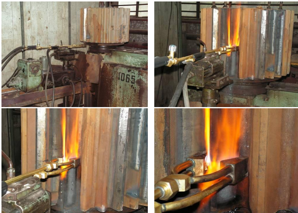
Рисунок 9 – Машинная закалка зубьев шестерни m = 25
