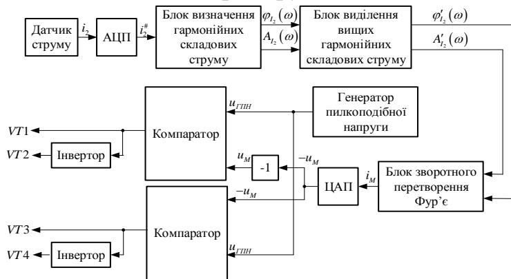
Рисунок 7 - Функціональна схема керування активною частиною КРП
