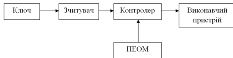
Рис. 1 – Структурна схема СКУД
