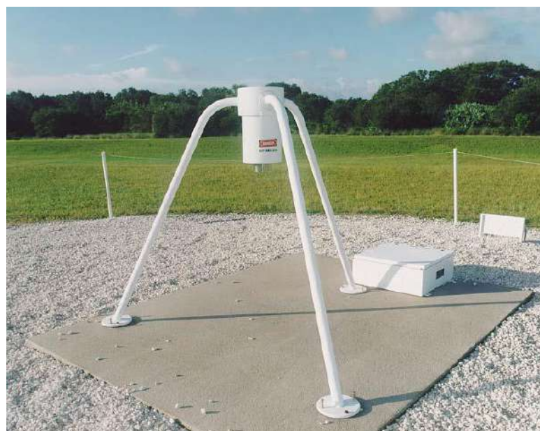
Рис. 3.3 – Внешний вид сенсора электрического поля типа «мельница» (An electric field mill) [3.7]
