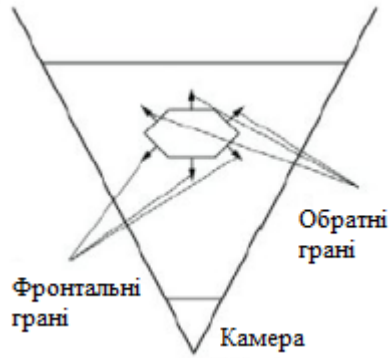
Рисунок 4.10 – Об'єкт з фронтальними і зворотними полігонами
