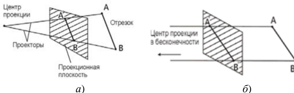
Рис. 4.13 – Види проекцій: а) – центральна, б) – паралельна
