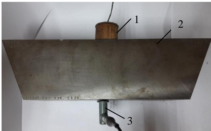
Рисунок 27 – Фото схеми дослідження діаграми спрямованості ЄП діаметром 30 мм:
