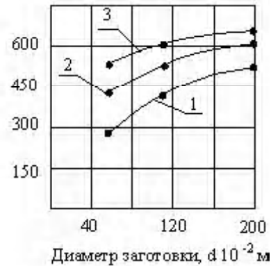
Рис. 3. Зависимость степени охлаждения заготовки от ее диаметра и толщины пленки омывающей заготовку воды: 1-3 – Кривые изменения температуры заготовки при толщинах пленки охлаждающей жидкости равных 1,0; 0,75 и 0,5 мм, соответственно
