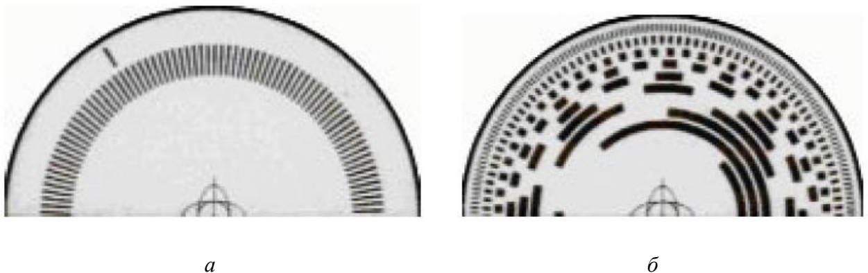
Рисунок 6 – Градуювальний диск інкрементального і абсолютного оптоелектронного датчика
