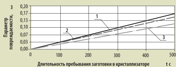
Рис. 5. Зависимость от длительности цикла параметра повреждаемости заготовки, движущейся со скоростью 0,02 м/с при использовании обратной направленности ее движения во время преодоления СТП: 1—3 — длительность цикла работы ГМНЛЗ, соответственно, 16,0; 12,0 и 8,0 с
