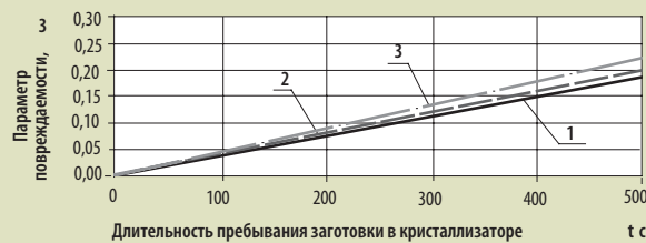
Рис. 4. Зависимость от длительности цикла изменения параметра повреждаемости заготовки, движущейся со скоростью 0,02 м/с при прямой направленности ее движения во время преодоления СТП: 1—3 — длительность цикла работы ГМНЛЗ, соответственно, 16,0; 12,0 и 8,0 с
