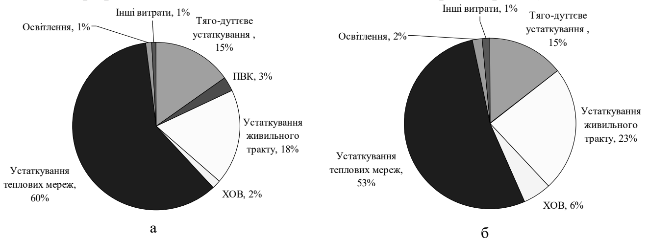
Рисунок 3 – Структура споживання електричної енергії на власні потреби типової ТЕЦ, що працює за тепловим графіком навантаження:
