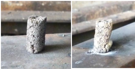
Рисунок 7.2 – Композиційний матеріал (Ti+V+C+Fe 2 O 3 +Al) після: а – формовки; б – СВЧ-процесу
