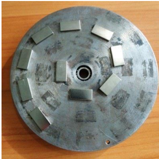
Рисунок 8 – Фізична модель магнітної системи дискового сепаратора
