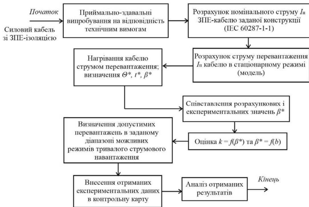
Рисунок 13 – Схема алгоритму для оцінки допустимого струмового перевантаження силового кабелю зі ЗПЕ-ізоляцією
