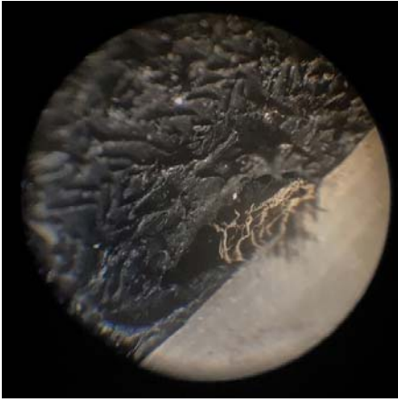
Рисунок 7 – Мікрофотографія місця пробою ЗПЕ-кабелю на межі напівпровідний екран-ізоляція
