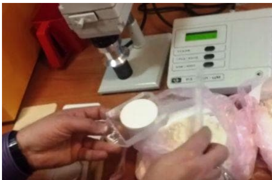
Рис. 4. Ущільнення та вирівнювання досліджуваного зразку
