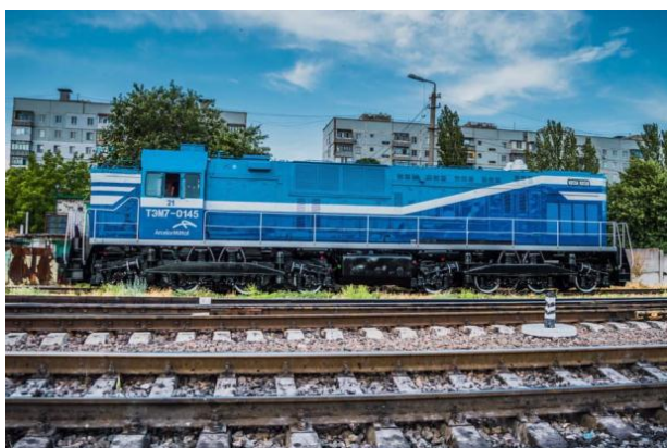
Рис. 1 Модернізований маневровий тепловоз ТЕМ7 з дизелем компанії АВС
