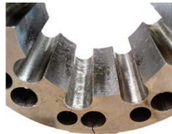
Рис. 8. Приводний корпус з задираками і тріщинами
