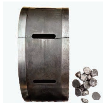
Рис. 9. Зруйнований приводний корпус, і кульки
