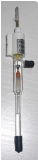
Рисунок 1.2 – Ртутно- сульфатний електрод порівняння
